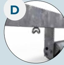
Crochets soudés en bas des arceaux. Évitent au filet de tomber sur les rouleaux
